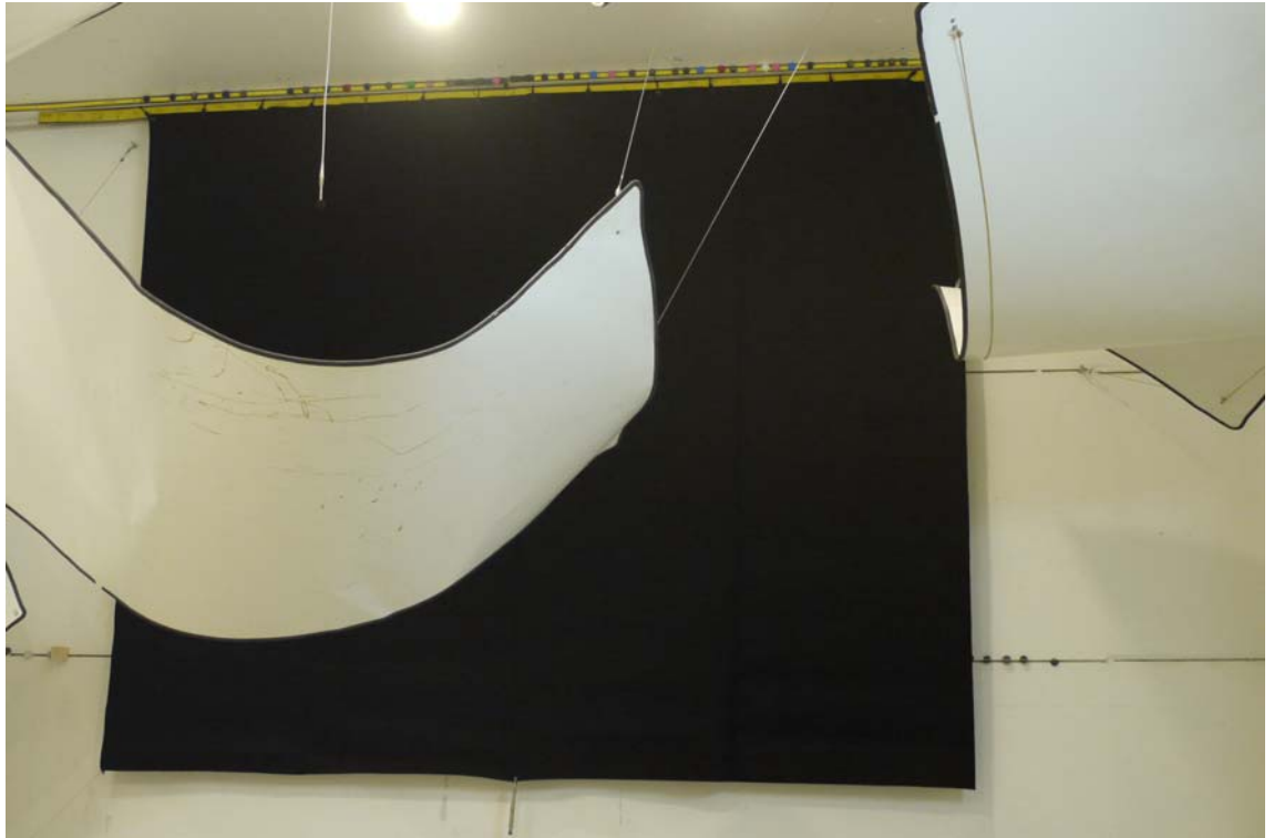
Foto B.1 Prüfaufbau im Hallraum – Filzgewebe ACOUFELT 1000 glatt hängend
