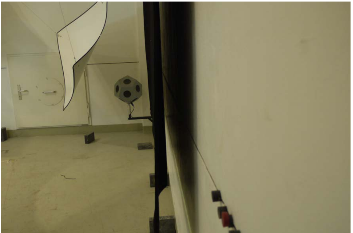
Foto B.2 Prüfaufbau im Hallraum – Filzgewebe ACOUFELT 1600, glatt hängend
