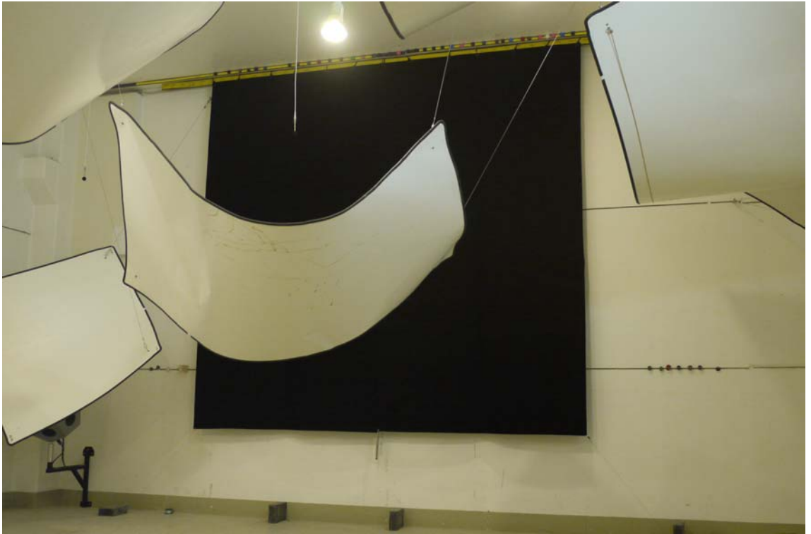
Foto B.1 Prüfaufbau im Hallraum – Filzgewebe ACOUFELT 1600, glatt hängend
