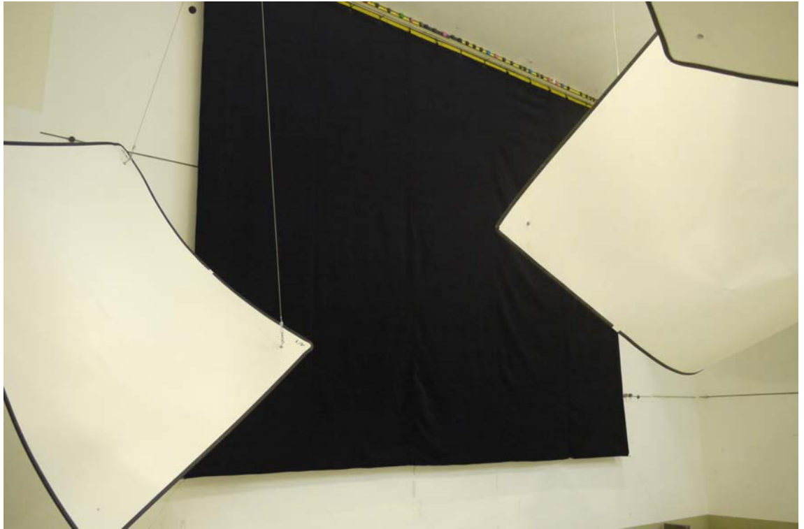
Foto B.1 Prüfaufbau im Hallraum – Samtgewebe AMADEE WP glatt hängend (Aufbau 1)
