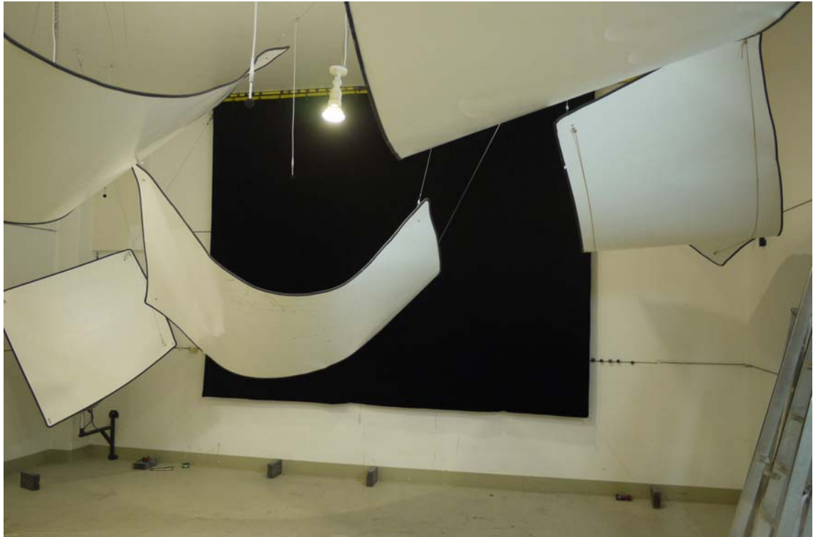
Foto B.1 Prüfungsaufbau im Hallraum – Bühnensamt MIDNIGHT glatt hängend (Aufbau 1)
